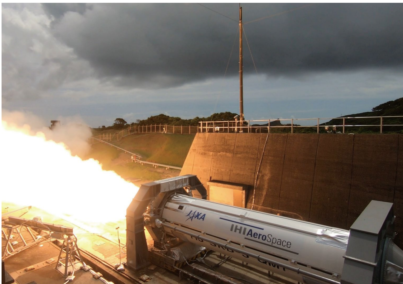
2019年8月21日に実施した、H3 ロケット用固体ロケットブースター（SRB-3）認定型モーターの地上燃焼試験の様子
