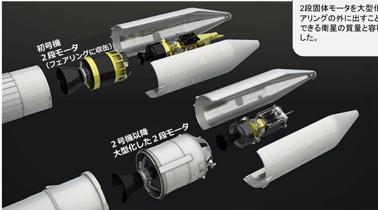
図1-3 イプシロンロケットの能力増強(2号機以降)
